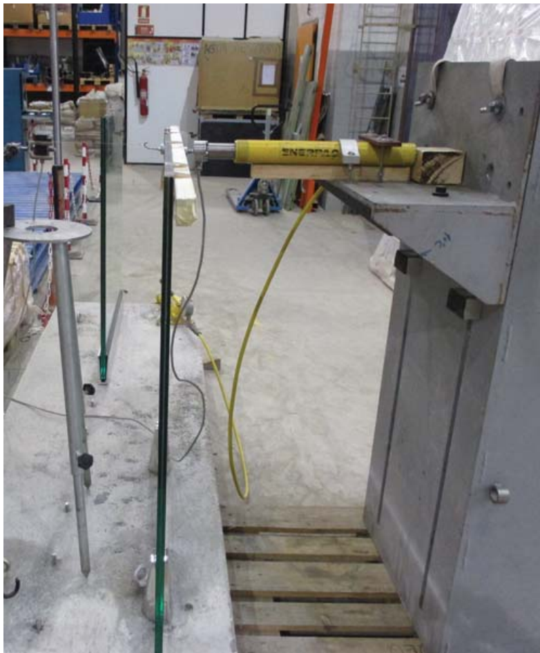
Aspecto del empuje horizontal hacia el exterior
