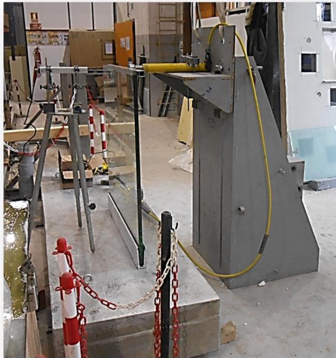
Aspecto tras el empuje horizontal hacia el exterior
