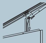
Este mecanismo instalado sobre el marco superior de una puerta de dos hojas, asegura el cierre de la hoja activa sobre la inactiva.
